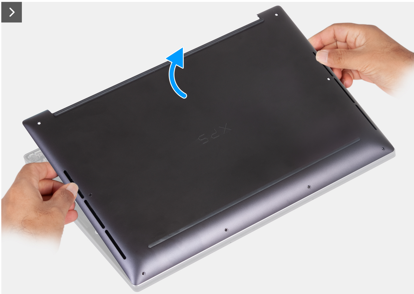
Figura 10. Scoaterea prin ridicare a capacului bazei de pe ansamblul suportului pentru palmă
