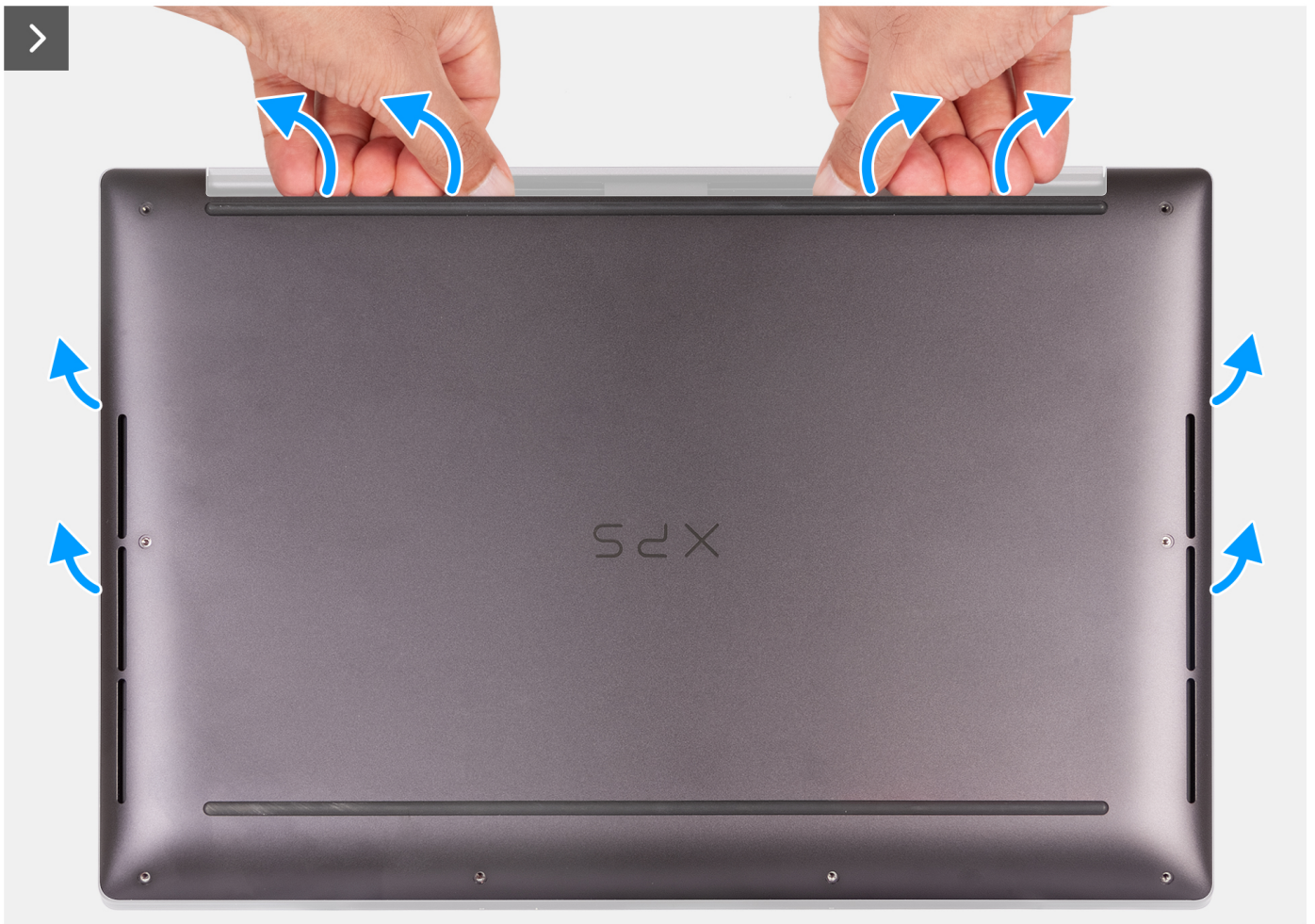
Figura 9. Utilizarea ambelor degete mari pentru desprinderea capacului bazei
